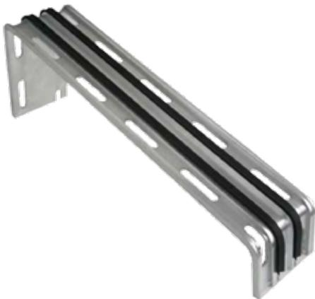
Die Halter für Mauerabdeckungen dienen gleichzeitig als Verbinder der einzelnen Profilängen und ermöglichen die temperaturbedingte Längendehnung der Abdeckung. Der Abstand der Halter richtet sich nach den örtlichen Windlasten. Die seitlichen Dichtungen dienen zur kontrollierten Wasserabführung im Stoßbereich.
